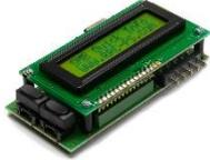
SMBus Reader                      | 100122           | 简单地读出 SMBus 电池数据。无需外部电源。5 路刀片连接器和 RS232 接口。              |
